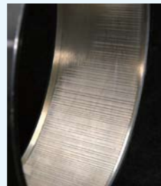
Stromdurchgang an Wälzlagern
